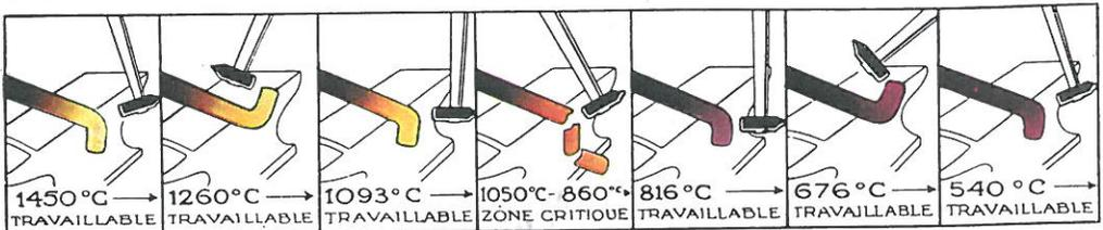
Faites cet essai sur un bout de barre ou une chute de tôle avant de travailler à chaud pour la première fois du fer pur "ARMCO"
